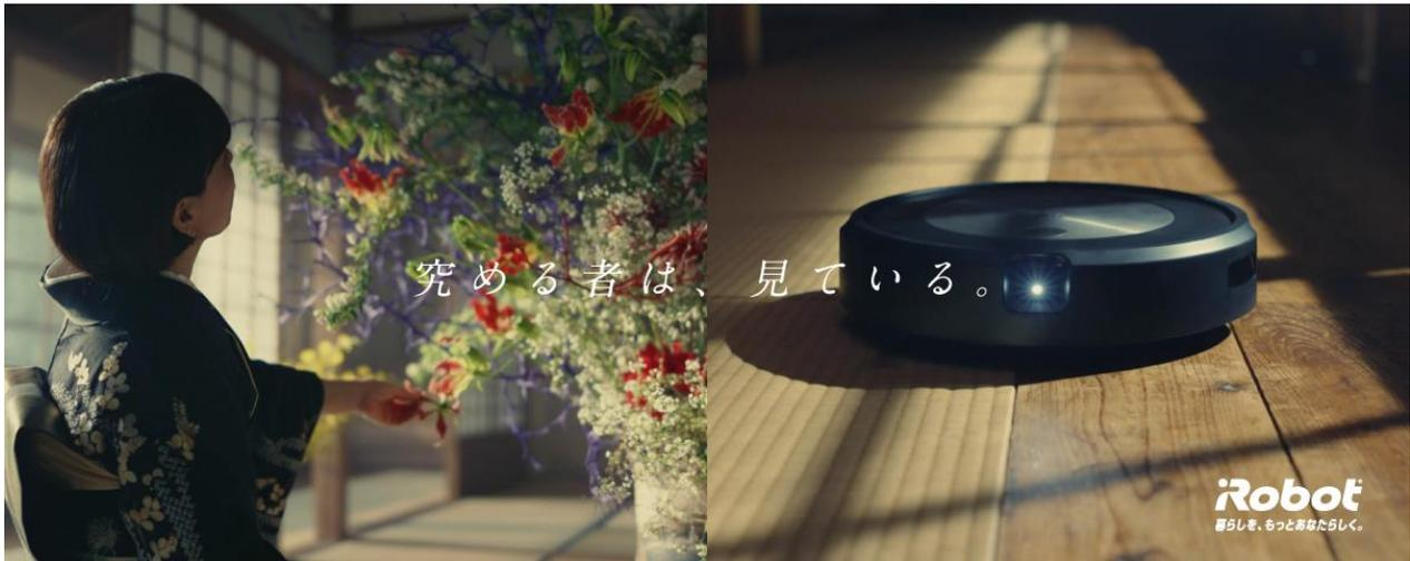
「ルンバ j7+」はアイロボットが30年以上にわたり培ってきたロボット技術やAI機能を集結させ開発したルンバ史上最高の賢さを誇る最新モデルです。最大の特徴は PrecisionVision(プレジジョンビジョン)ナビゲーションの搭載で、ルンバで初めてロボット前面に搭載されたカメラにより、目の前にあるコードやペットの排泄物<sup>1</sup>などの障害物を識別して回避するため散らかった床でも掃除することができます。さらに、清掃中に障害物が見つかったら、清掃終了後にアプリ上にその画像が表示され、これらの障害物に今後どのように対処すべきかを、アイロボットが管理するクラウド上にユーザーが任意でフィードバックできます。この世界中のユーザーからのフィードバックが収集される<sup>2</sup> ことにより、データベースが更新され、ロボット自身が学習、進化を続けます。“ユーザー参加型 AI ロボット”とよばれるこの全く新しいシステムは、世界60か国以上で販売され、4,000万台以上<sup>3</sup>の累計販売台数を誇るアイロボット独自のロボット掃除機「ルンバ」ならではの強みです。
