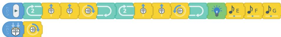
(工夫点) 壁にぶつかったら進行方向を変える／終了したら光と音で知らせる
